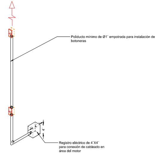
\*Tubería y registro eléctricos suministrados por el cliente, únicamente ductería sin cableado
