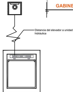
**NOTA:** Por cada nivel adicional deberá colocar una chalupa para alojar el botón de llamado y debería de continuar la tubería hasta esta.
