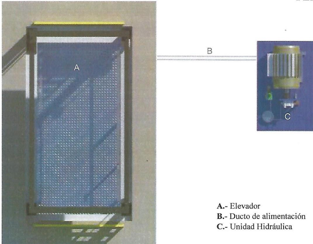
**NOTA:** La distancia B se cubrirá de ser posible con ductos realizados con tubería, y la salida en el foso será recomendable ubicarla del lado donde se encontraran las columnas y el resto de la estructura del elevador. En caso de que no se pueda instalar estos ductos se empleara una canalización diferente que proteja el cableado. En cualquiera de los dos casos esta será suministrada por parte de Tecno Rampa, y los trabajos para su instalación lo hará el equipo de la empresa.
