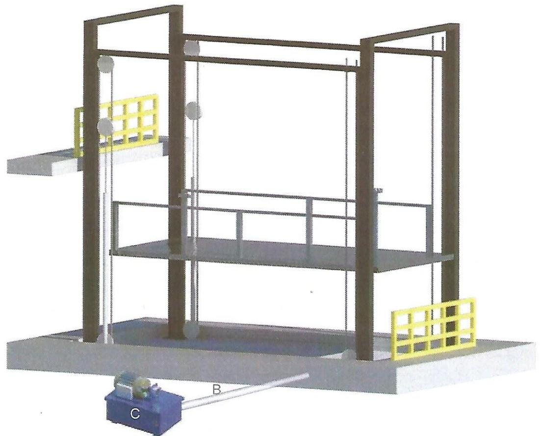
La unidad hidráulica y control eléctrico deberán ser instalados fuera del foso y ubicarse en un lugar libre de polvo, líquidos e inclemencias del clima, evitando que se contamine el aceite y se pierda la garantía del equipo.
