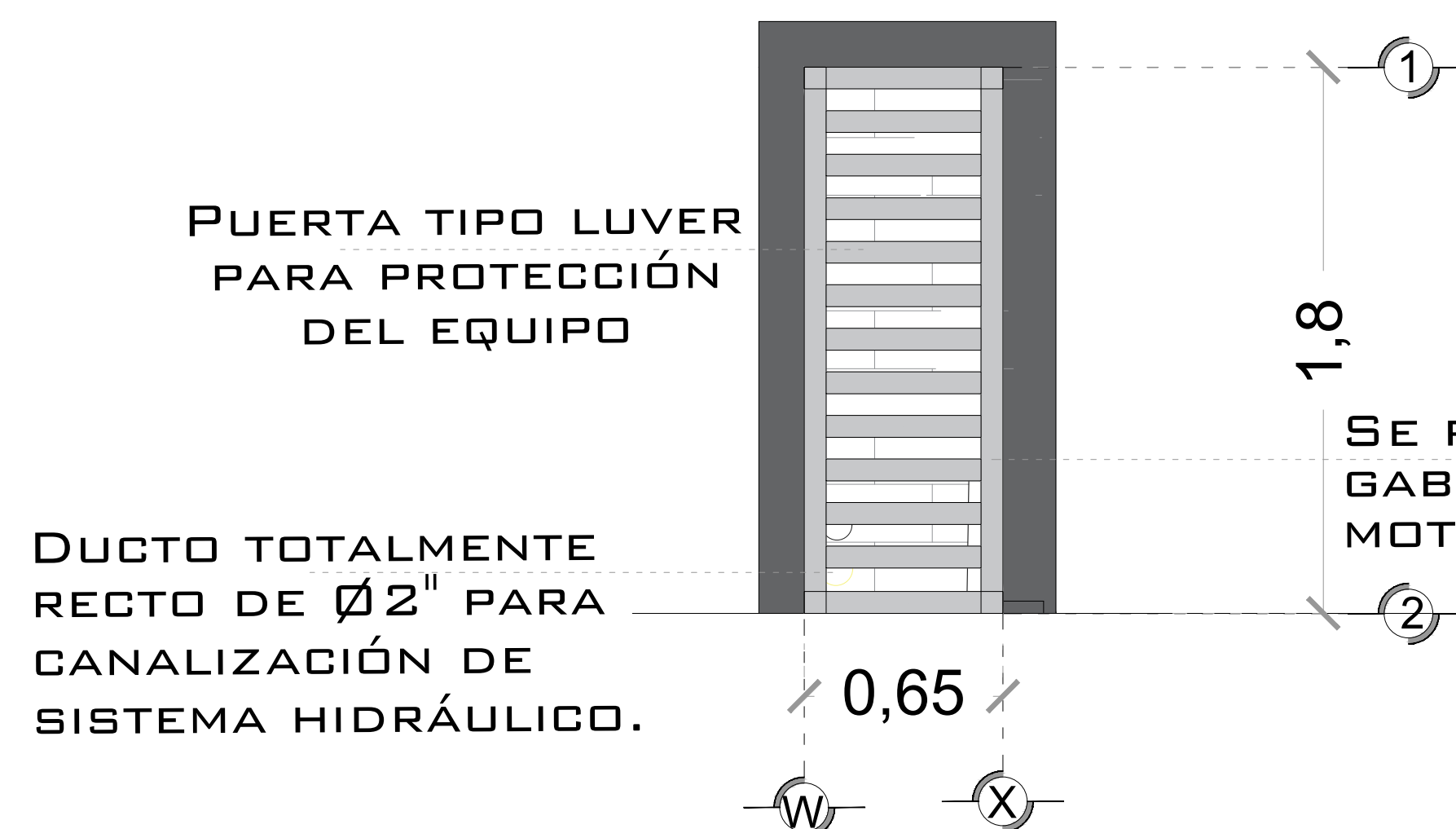
DESCRIPCION DE UNIDAD HIDRAULICA GABINETE (VISTA FRONTAL)
