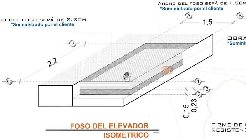
OBRA CIVIL PARA EL ANCLAJE DEL EQUIPO
