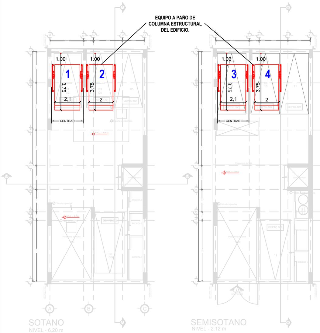
CANALIZACIÓN INFERIOR. CONTACTO Y CLAVIJA DE MEDIO GIRO A PAÑO DE INICIO DE EQUIPO A 40CM DE ALTURA EN REFERENCIA DE N.P.T.
