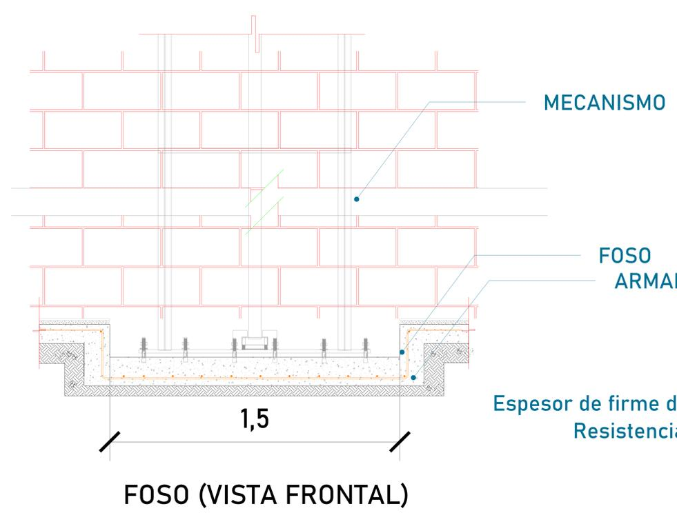
Espesor de firme de concreto armado. Resistencia de  $F' C = 250 \text{ kg/cm}^2$
