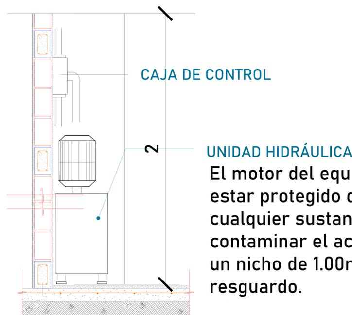
El cliente suministra, instala y energiza centro de carga con alimentación monofásica a 110V, con neutro y tierra física, e interruptor termomagnético de 1 x 30 Amp exclusivo para el elevador, al igual que la canalización de botoneras, las cuales rematan a una caja registro, lo anterior y el centro de carga deberán colocarse en el área donde se ubique la unidad hidráulica y control eléctrico proporcionado por TECNORAMPA a no mayor de 5.00m del área del equipo.
