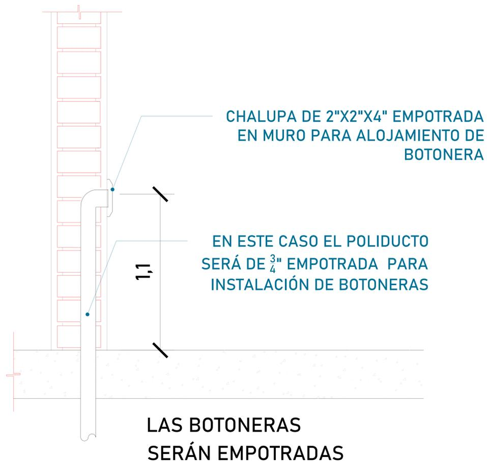
Para que las botoneras queden empotradas se solicita al cliente tener un poliducto de  $\varnothing 1 \frac{1}{4}$  " por donde se quiere tener las botoneras de llamado del equipo Tecnorampa. Esta canalización rematan a la caja de control electrico (espacio designado para el motor del elevador)
