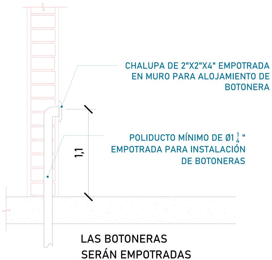
Para que las botoneras queden empotradas se solicita al cliente tener un poliducto de Ø1 1/4" por donde se quiere tener las botoneras de llamado del equipo Tecnorampa. Esta canalización rematan a la caja de control electrico (espacio designado para el motor del elevador)
