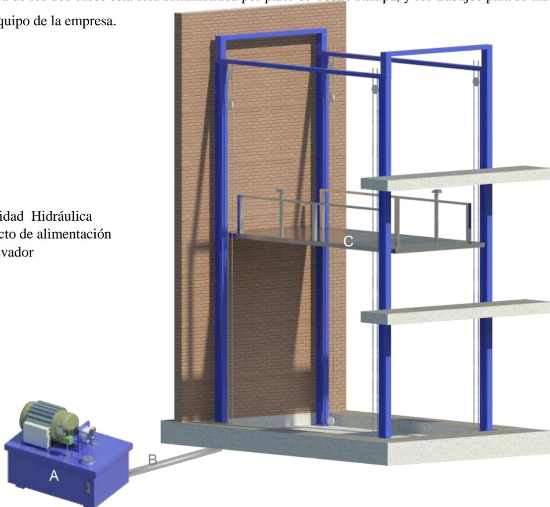
La unidad hidráulica y control eléctrico deberán ser instalados fuera del foso y ubicarse en un lugar libre de polvo, líquidos e inclemencias del clima, evitando que se contamine el aceite y se pierda la garantía del equipo.
