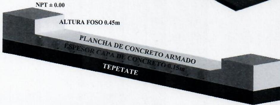
Se recomienda el uso de concreto con una resistencia mínima de  $f'c=250\text{kg/cm}^2$  armado con malla electro soldada 6.6 10.10 delgada después de los primeros 10cm para el mejor anclaje del equipo, a lo largo y ancho del área de instalación
