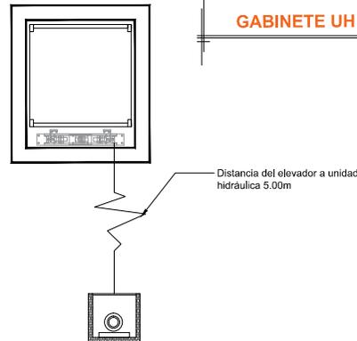
**NOTA:** Por cada nivel adicional deberá de colocar una chalupa para alojar el botón de llamado y deberá de continuar la tubería hasta esta.
