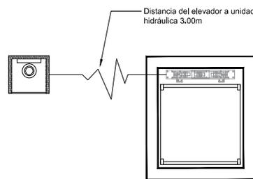
**NOTA:** Por cada nivel adicional deberá de colocar una chalupa para alojar el botón de llamado y debería de continuar la tubería hasta esta.
