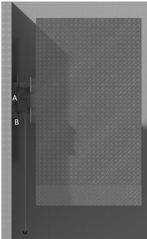
La unidad hidráulica se ubicara sobre la columna del lado derecho de la misma, por lo que será necesaria la colocación por parte del cliente de una caja de registro, la cual se puede colocar en forma elevada sobre el firme a unos 50 cm de separación de este.
