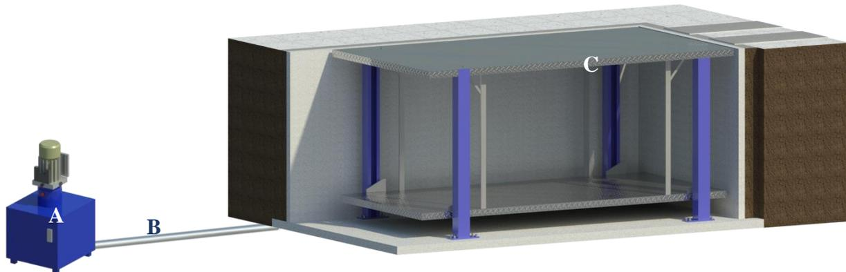
La unidad hidráulica y control eléctrico deberán ser instalados fuera del foso y ubicarse en un lugar libre de polvo, líquidos e inclemencias del clima, evitando que se contamine el aceite y se pierda la garantía del equipo.
