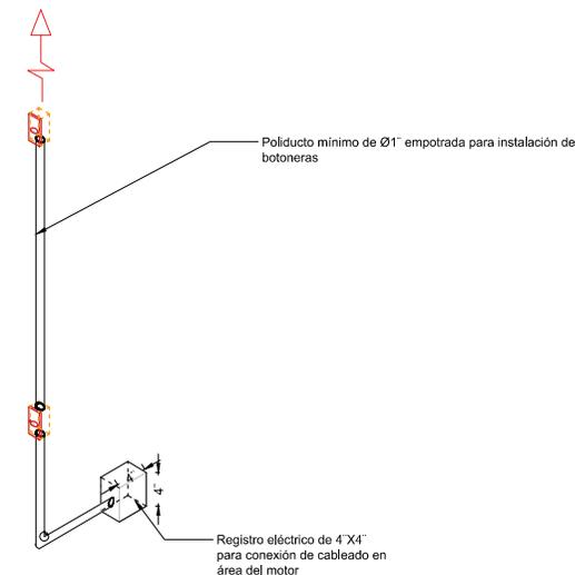
\*Tubería y registro eléctricos suministrados por el cliente, únicamente ductería sin cableado
