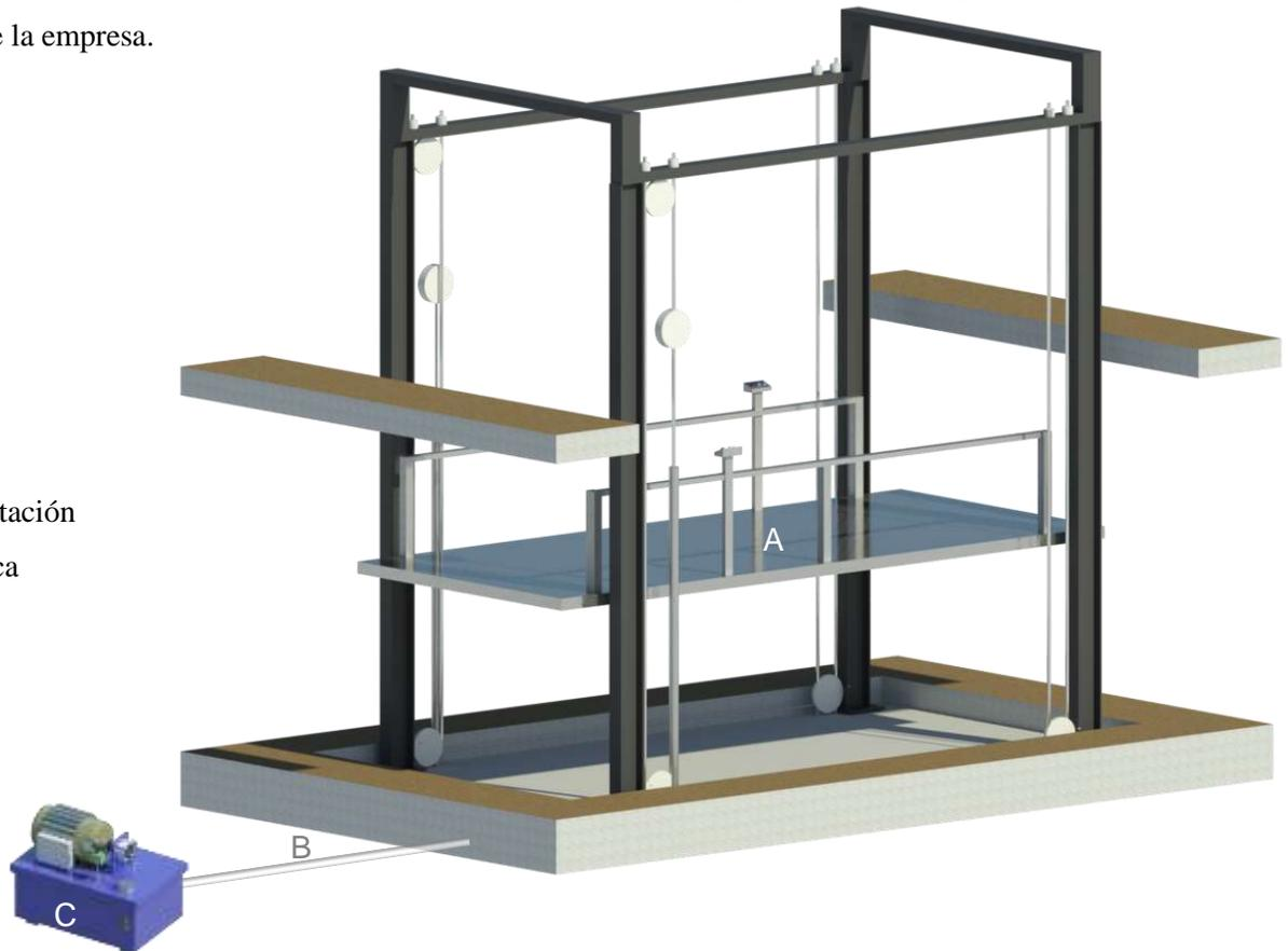
La unidad hidráulica y control eléctrico deberán ser instalados fuera del foso y ubicarse en un lugar libre de polvo, líquidos e inclemencias del clima, evitando que se contamine el aceite y se pierda la garantía del equipo.
