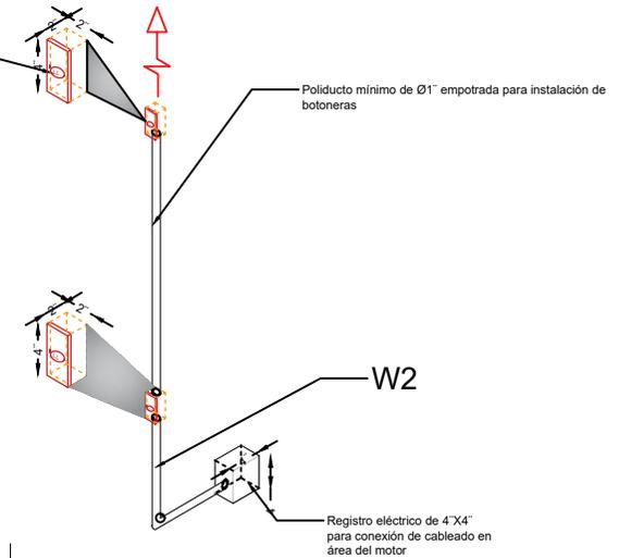
\*Tubería y registro eléctricos suministrados por el cliente, únicamente ductería sin cableado
