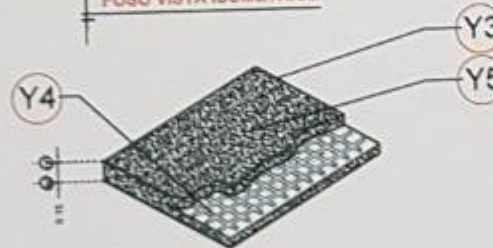
ARMADO DE FIRME
