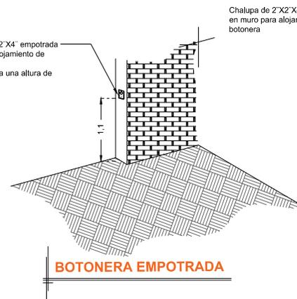
**NOTA:** Por cada nivel adicional deberá de colocar una chalupa para alojar el botón de llamado y debería de continuar la tubería hasta esta.
