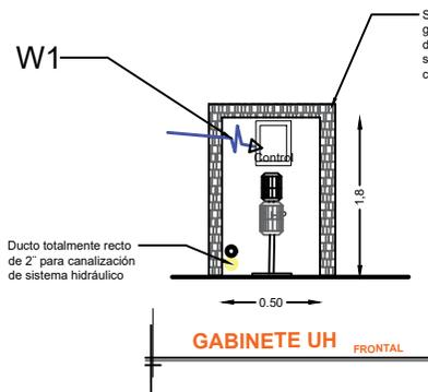
Alimentación monofásica a 110 V, con neutro y tierra física, con break termomagnético de protección y 25 Amp libres de consumo
