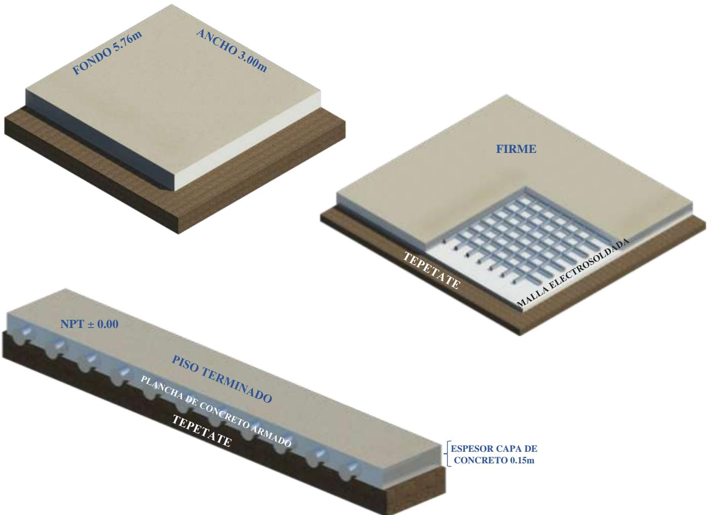
Se recomienda el uso de concreto con una resistencia mínima de  $f'c=250\text{kg/cm}^2$  armado con malla electro soldada 6.6 10.10 delgada después de los primeros 10cm para el mejor anclaje del equipo, a lo largo y ancho del área de instalación
