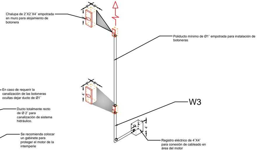
\*Tubería y registro eléctricos suministrados por el cliente, únicamente ductería sin cableado (DEJAR GUIADO CANALIZACIÓN)
