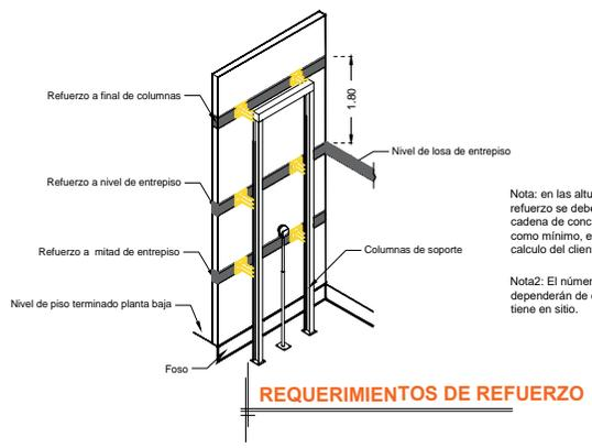
Nota: en las alturas indicadas de refuerzo se deberá de colocar una cadena de concreto  $f'_{c}=250\text{ kg}/\text{cm}^2$  como mínimo, el armado dependerá del calculo del cliente.
