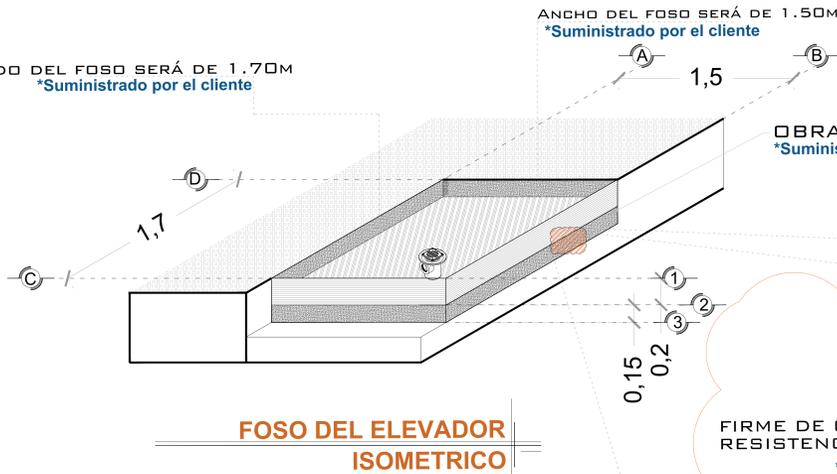
OBRA CIVIL PARA EL ANCLAJE DEL EQUIPO
