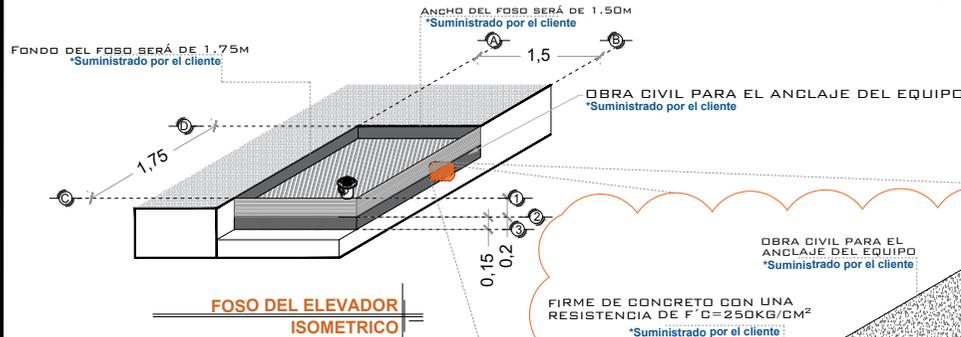
FIRME DE CONCRETO CON UNA RESISTENCIA DE F' C=250KG/CM<sup>2</sup>
