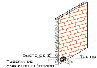
LA DISTANCIA "B" SE CUBRIRÁ DE SER POSIBLE CON DUCTOS REALIZADOS CON TUBERÍA Y LA SALIDA EN EL FOSO SERÁ RECOMENDABLE UBICARLA DEL LADO DONDE SE ENCONTRARAN LAS COLUMNAS Y EL RESTO DE LA ESTRUCTURA DEL ELEVADOR. EN CASO DE QUE NO SE PUEDA INSTALAR ESTOS DUCTOS SE EMPLEARA UNA CANALIZACIÓN DIFERENTE QUE PROTEJA EL CABLEADO. EN CUALQUIERA DE LOS DOS CASOS ESTÁ SERÁ SUMINISTRADA POR PARTE DE TECNOGRAMPA Y LOS TRABAJOS PARA SU INSTALACIÓN LO HARÁ EL EQUIPO DE LA EMPRESA.
