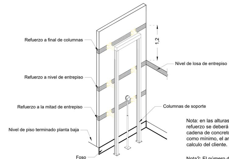
**Nota:** en las alturas indicadas de refuerzo se deberá de colocar una cadena de concreto  $f'c=250\text{ kg}/\text{cm}^2$  como mínimo, el armado dependerá del calculo del cliente.
