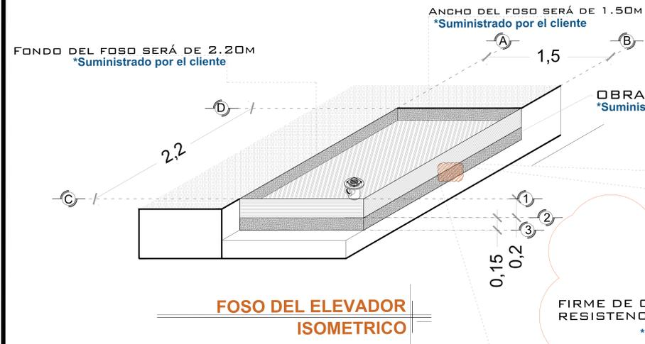
OBRA CIVIL PARA EL ANCLAJE DEL EQUIPO
