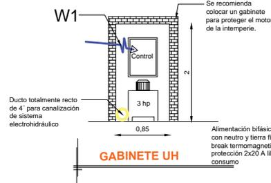
Alimentación bifásica a 220 V, con neutro y tierra física, con break termomagnético de protección 2x20 A libras de consumo
