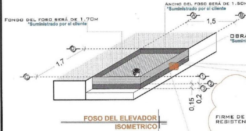
OBRA CIVIL PARA EL ANCLAJE DEL EQUIPO
