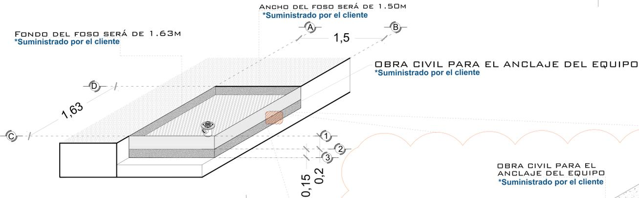
FIRME DE CONCRETO CON UNA RESISTENCIA DE F' C=250KG/CM<sup>2</sup>
