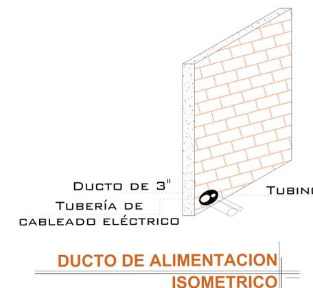
LA DISTANCIA "B" SE CUBRIRÁ DE SER POSIBLE CON DUCTOS REALIZADOS CON TUBERÍA Y LA SALIDA EN EL FOSO SERÁ RECOMENDABLE UBICARLA DEL LADO DONDE SE ENCONTRARÁN LAS COLUMNAS Y EL RESTO DE LA ESTRUCTURA DEL ELEVADOR. EN CASO DE QUE NO SE PUEDA INSTALAR ESTOS DUCTOS SE EMPLEARÁ UNA CANALIZACIÓN DIFERENTE QUE PROTEJA EL CABLEADO. EN CUALQUIERA DE LOS DOS CASOS ESTÁ SERÁ SUMINISTRADA POR PARTE DE TECNORAMPA Y LOS TRABAJOS PARA SU INSTALACIÓN LO HARÁ EL EQUIPO DE LA EMPRESA.
