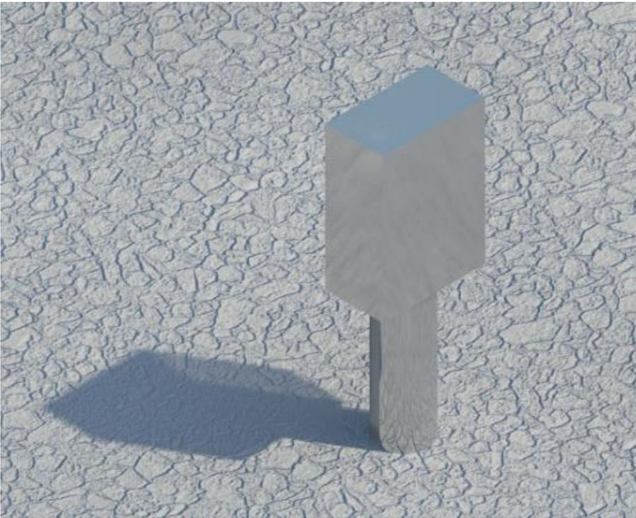
En la caja de registro eléctrico que se instale, se deberá colocar la clavija de medio giro, esto con la finalidad de realizar la conexión de la alimentación con la unidad hidráulica, y facilitar que posteriormente el usuario, en caso de emergencia, necesite deshabilitar la alimentación del equipo, únicamente tenga de desenchufar la clavija como lo haría con cualquier otro equipo eléctrico.
