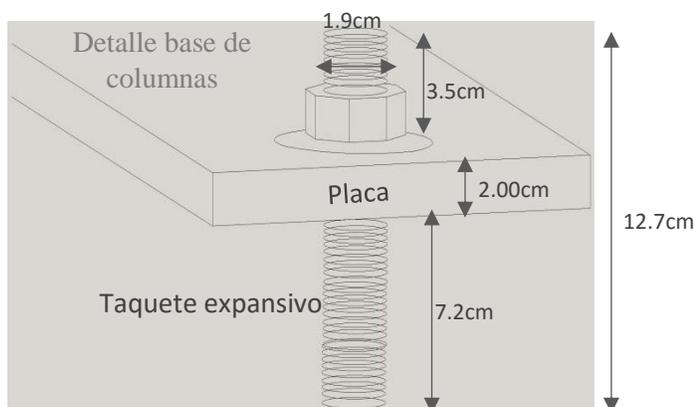
Para la correcta instalación del equipo, es necesario que la base del concreto sea armado con malla electrosoldada 66.10.10, donde se deberá de utilizar concreto con una resistencia de  $f''c=250$  kg/cm<sup>2</sup> y un espesor de 0.15 m
