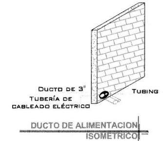
LA DISTANCIA "B" SE CUBRIRÁ DE SER POSIBLE CON DUCTOS REALIZADOS CON TUBERÍA Y LA SALIDA EN EL FOSO SERÁ RECOMENDABLE UBICARLA DEL LADO DONDE SE ENCONTRARÁN LAS COLUMNAS Y EL RESTO DE LA ESTRUCTURA DEL ELEVADOR. EN CASO DE QUE NO SE PUEDA INSTALAR ESTOS DUCTOS SE EMPLEARÁ UNA CANALIZACIÓN DIFERENTE QUE PROTEJA EL CABLEADO. EN CUALQUIERA DE LOS DOS CASOS ESTÁ SERÁ SUMINISTRADA POR PARTE DE TECNORAMPA Y LOS TRABAJOS PARA SU INSTALACIÓN LO HARÁ EL EQUIPO DE LA EMPRESA.
