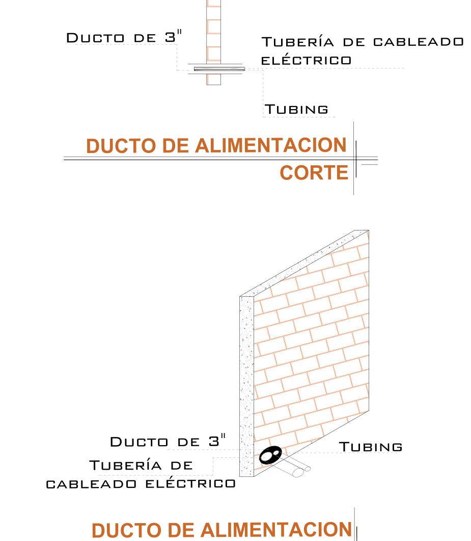
LA DISTANCIA "B" SE CUBRIRÁ DE SER POSIBLE CON DUCTOS REALIZADOS CON TUBERÍA Y LA SALIDA EN EL FOSO SERÁ RECOMENDABLE UBICARLA DEL LADO DONDE SE ENCONTRARAN LAS COLUMNAS Y EL RESTO DE LA ESTRUCTURA DEL ELEVADOR. EN CASO DE QUE NO SE PUEDA INSTALAR ESTOS DUCTOS SE EMPLEARA UNA CANALIZACIÓN DIFERENTE QUE PROTEJA EL CABLEADO. EN CUALQUIERA DE LOS DOS CASOS ESTÁ SERÁ SUMINISTRADA POR PARTE DE TECNORAMPA Y LOS TRABAJOS PARA SU INSTALACIÓN LO HARÁ EL EQUIPO DE LA EMPRESA.
