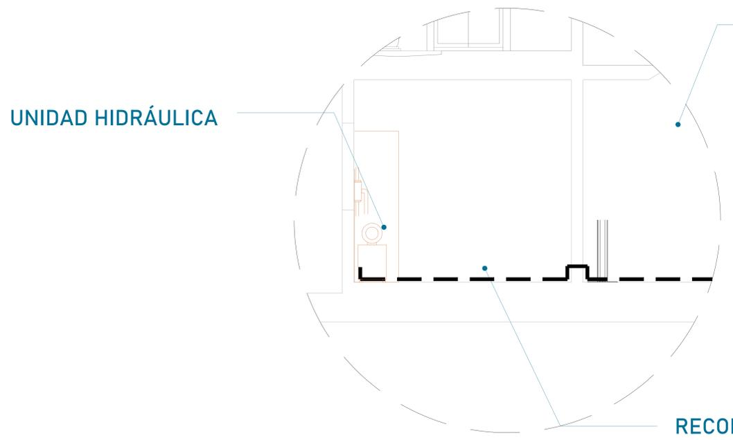
El tubing que es la conexión del mecanismo del elevador a la Unidad Hidráulica, donde pasa el aceite. No tiene que tener una distancia máxima de 5.00m lineales.
