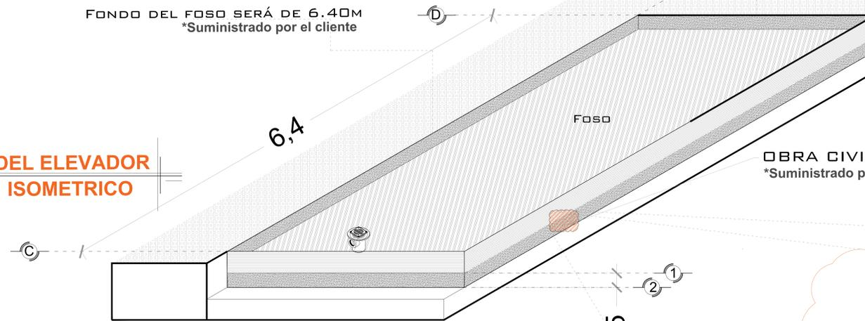
OBRA CIVIL PARA EL ANCLAJE DEL EQUIPO
