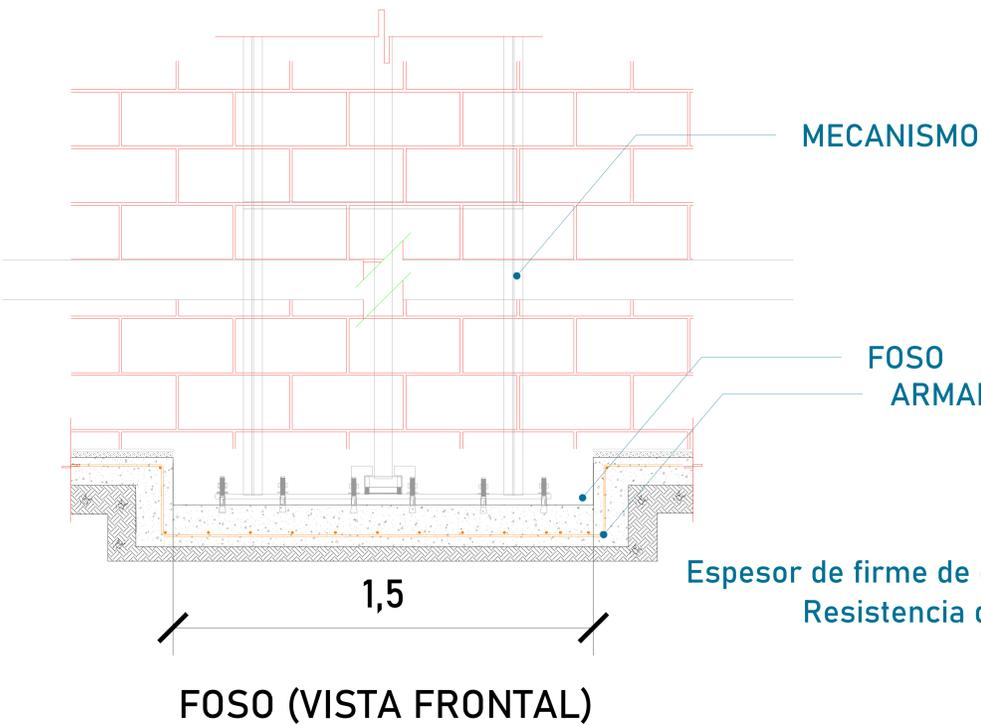
Esesor de firme de concreto armado. Resistencia de  $F'C = 250 \text{ kg/cm}^2$
