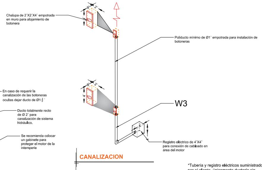
\*Tubería y registro eléctricos suministrados por el cliente, únicamente ductería sin cableado
