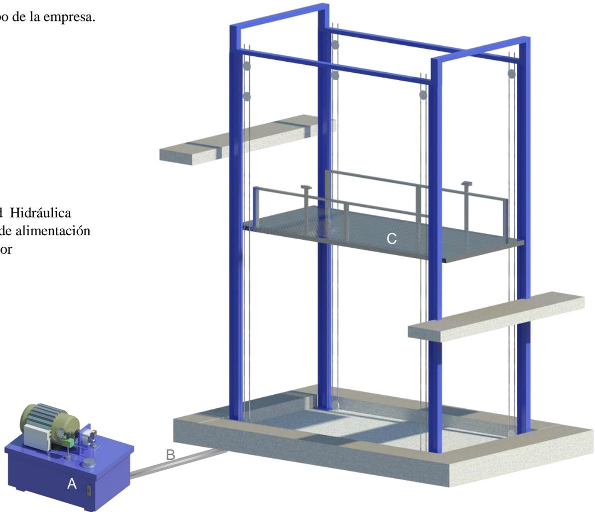
La unidad hidráulica y control eléctrico deberán ser instalados fuera del foso y ubicarse en un lugar libre de polvo, líquidos e inclemencias del clima, evitando que se contamine el aceite y se pierda la garantía del equipo.
