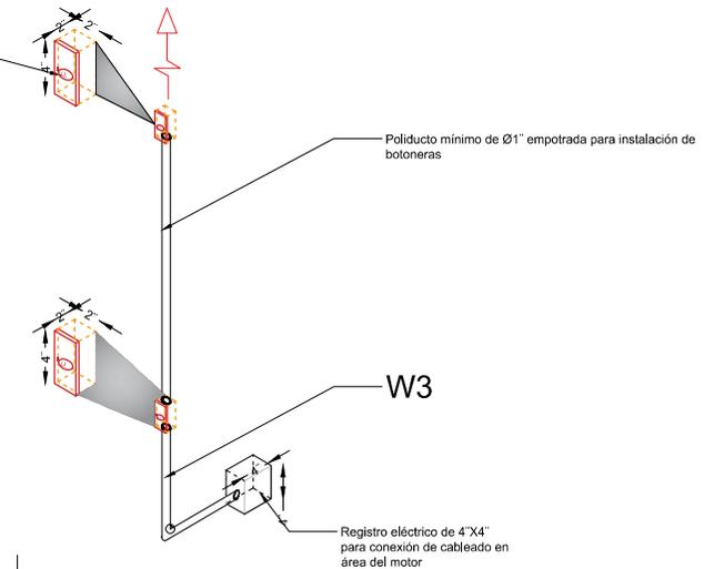
\*Tubería y registro eléctricos suministrados por el cliente, únicamente ductería sin cableado
