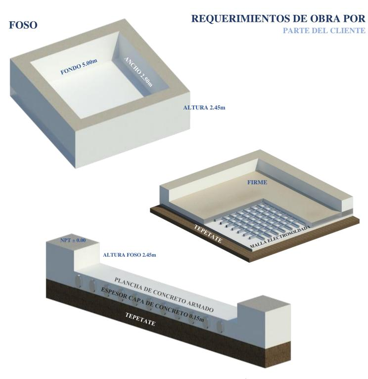
Se recomienda el uso de concreto con una resistencia mínima de f´c=250kg/cm² armado con malla electro soldada 6.6 10.10 delgada después de los primeros 10cm para el mejor anclaje del equipo, a lo largo y ancho del área de instalación
