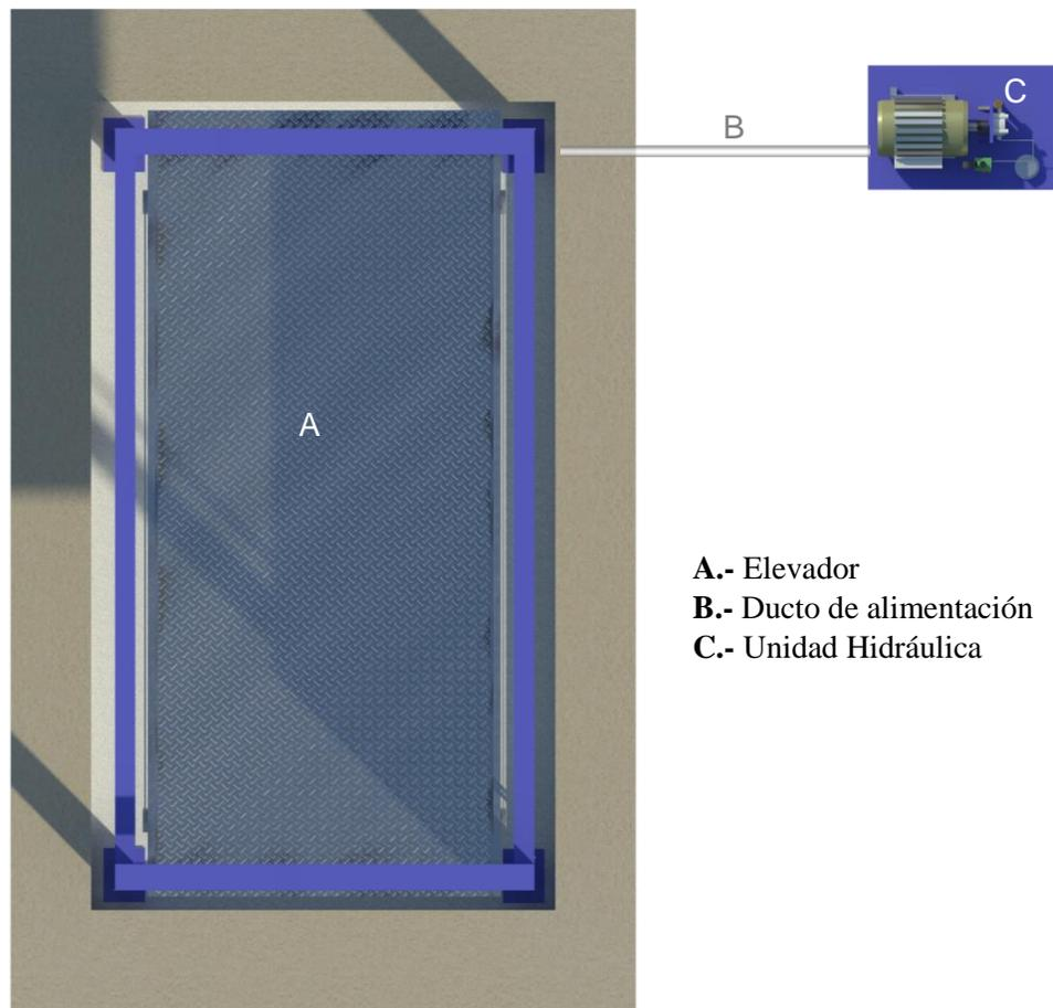
**NOTA:** La distancia B se cubrirá de ser posible con ductos realizados con tubería, y la salida en el foso será recomendable ubicarla del lado donde se encontraran las columnas y el resto de la estructura del elevador. En caso de que no se pueda instalar estos ductos se empleara una canalización diferente que proteja el cableado. En cualquiera de los dos casos esta será suministrada por parte de Tecno Rampa, y los trabajos para su instalación lo hará el equipo de la empresa.
