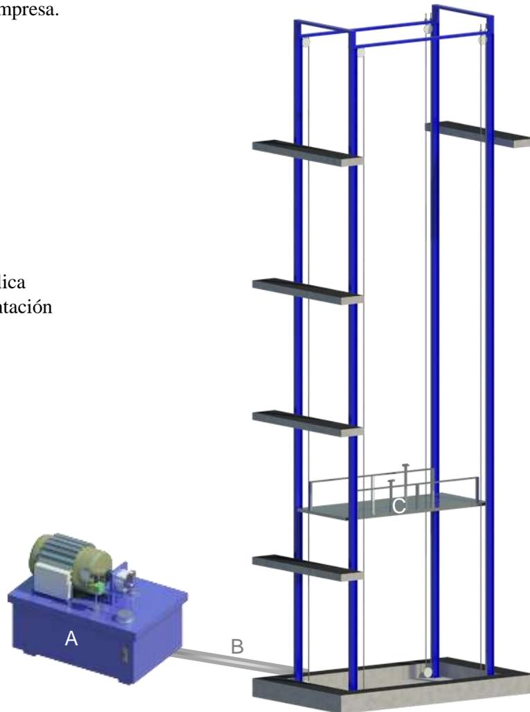
La unidad hidráulica y control eléctrico deberán ser instalados fuera del foso y ubicarse en un lugar libre de polvo, líquidos e inclemencias del clima, evitando que se contamine el aceite y se pierda la garantía del equipo.
