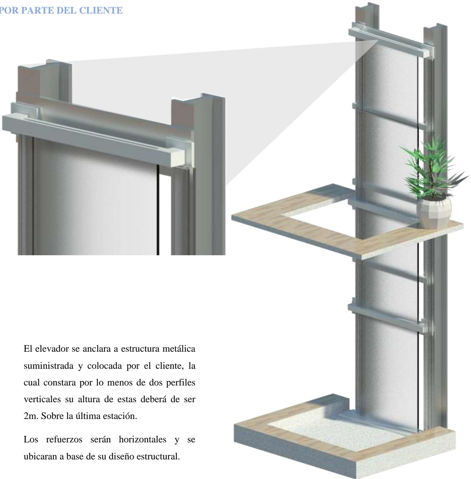
El elevador se anclara a estructura metálica suministrada y colocada por el cliente, la cual constara por lo menos de dos perfiles verticales su altura de estas deberá de ser 2m. Sobre la última estación.
