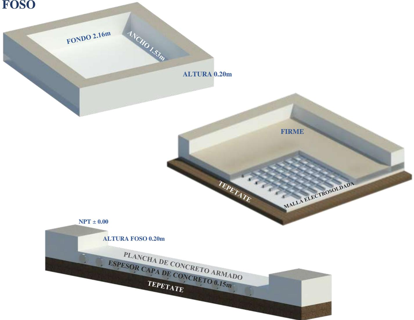
Se recomienda el uso de concreto con una resistencia mínima de  $f'c=250\text{kg/cm}^2$  armado con malla electro soldada 6.6 10.10 delgada después de los primeros 10cm para el mejor anclaje del equipo, a lo largo y ancho del área de instalación
