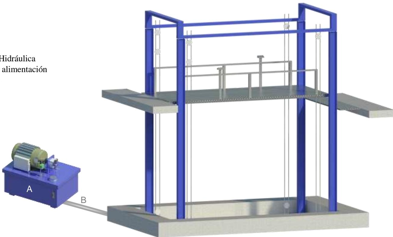
La unidad hidráulica y control eléctrico deberán ser instalados fuera del foso y ubicarse en un lugar libre de polvo, líquidos e inclemencias del clima, evitando que se contamine el aceite y se pierda la garantía del equipo.
