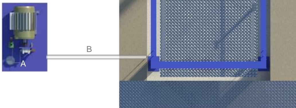
**NOTA:** La distancia B se cubrirá de ser posible con ductos realizados con tubería, y la salida en el foso será recomendable ubicarla del lado donde se encontraran las columnas y el resto de la estructura del elevador. En caso de que no se pueda instalar estos ductos se empleara una canalización diferente que proteja el cableado. En cualquiera de los dos casos esta será suministrada por parte de Tecno Rampa, y los trabajos para su instalación lo hará el equipo de la empresa.
