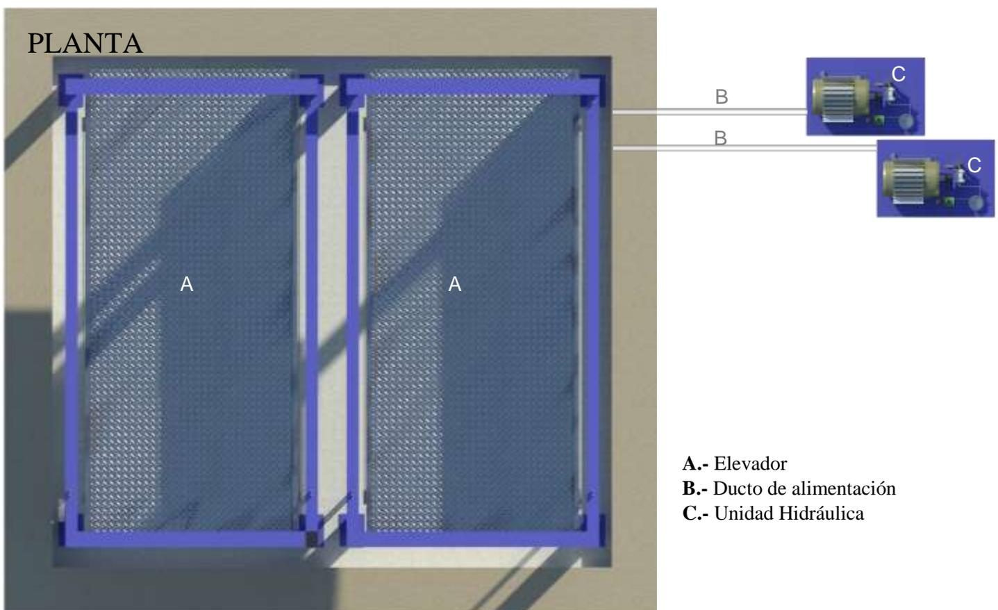
**NOTA:** La distancia B se cubrirá de ser posible con ductos realizados con tubería, y la salida en el foso será recomendable ubicarla del lado donde se encontraran las columnas y el resto de la estructura del elevador. En caso de que no se pueda instalar estos ductos se empleara una canalización diferente que proteja el cableado. En cualquiera de los dos casos esta será suministrada por parte de Tecno Rampa, y los trabajos para su instalación lo hará el equipo de la empresa.
