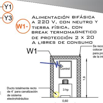
ALIMENTACIÓN BIFÁSICA A 220 V, CON NEUTRO Y TIERRA FÍSICA, CON BREAK TERMOMAGNETICO DE PROTECCIÓN 2 X 20 A LIBRES DE CONSUMO
