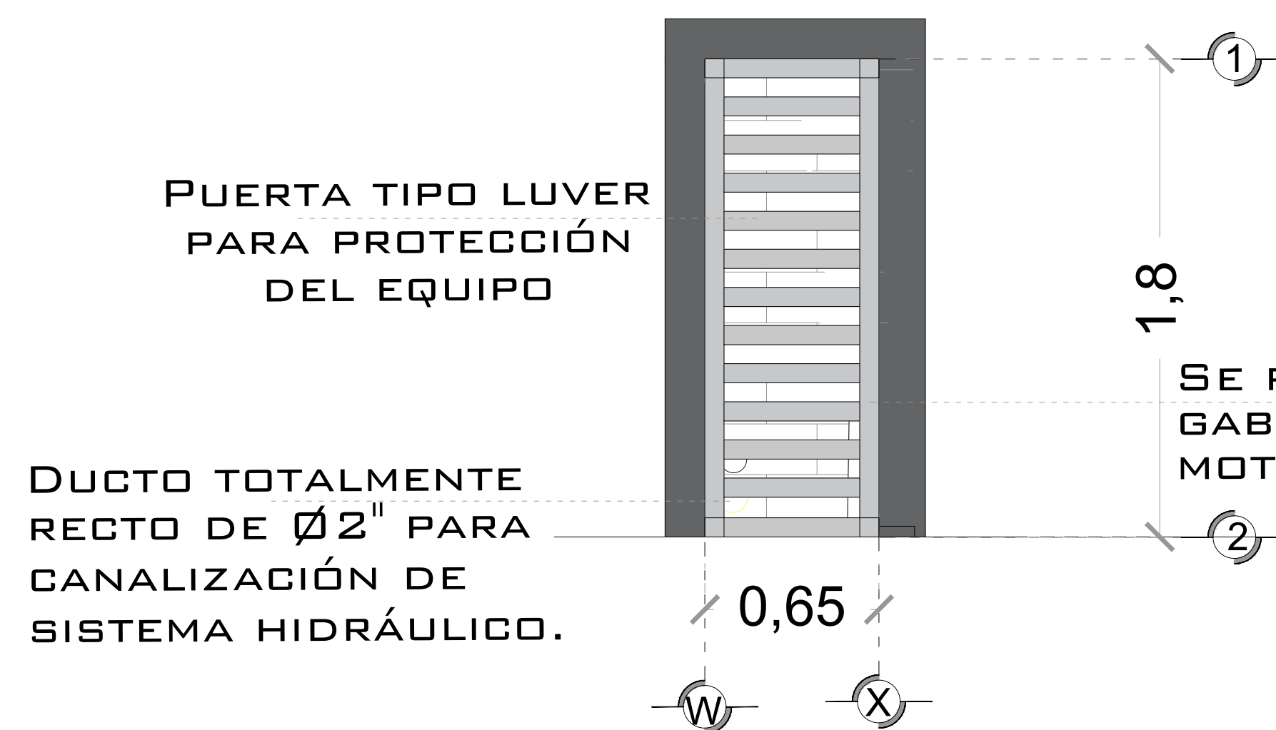
DESCRIPCION DE UNIDAD HIDRAULICA GABINETE (VISTA FRONTAL)
